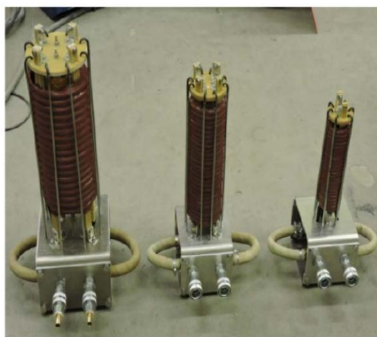
Рисунок 2. Индукционный нагреватель обмоток СЭЛТ-1141-40(80)/22
