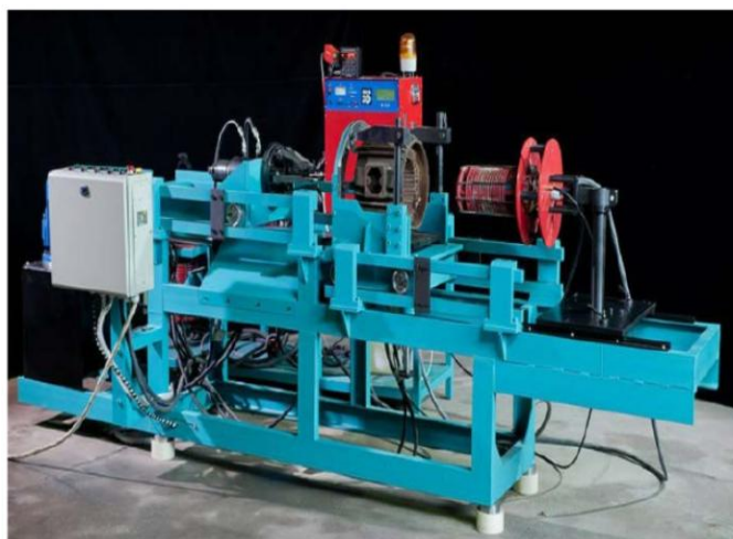
Рисунок 2. Индукционный нагреватель обмоток СЭЛТ-1141-40(80)/22
