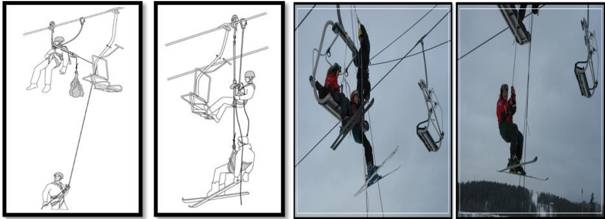
Рис.1.Алгоритм спасения с кресельной канатной дороги.
