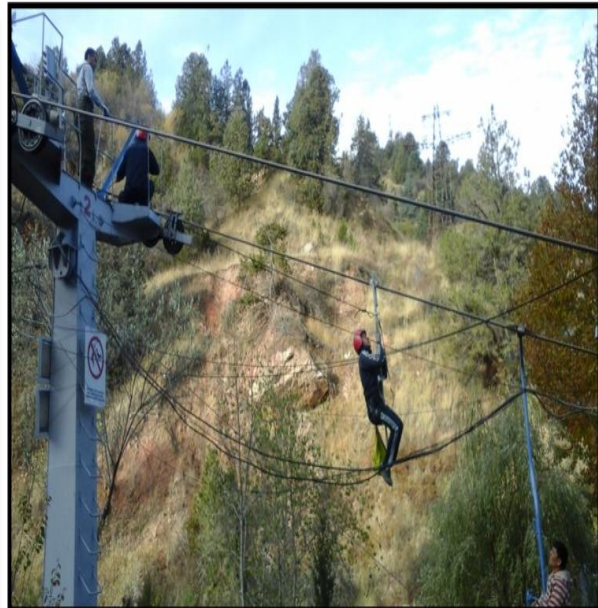
Рис.6. Передвижение спасателя по несущему канату.
